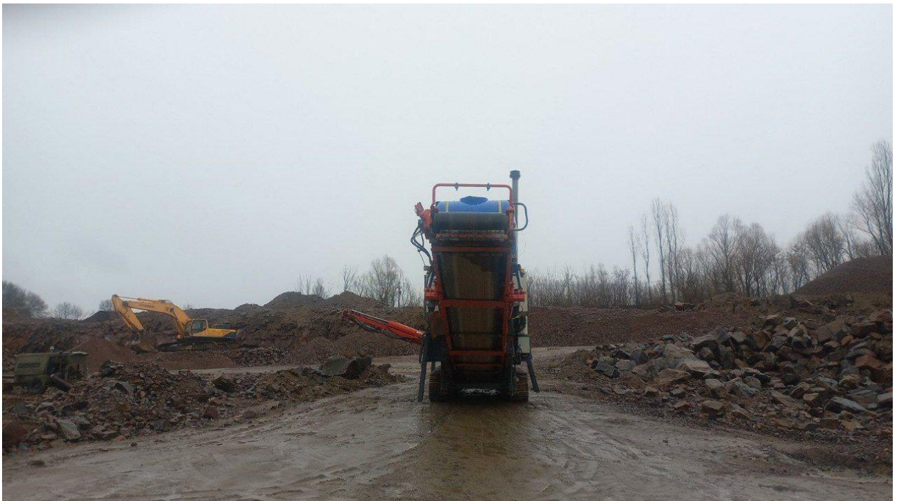
Рис.1 Самохідна дробарка із зрошувальною системою
