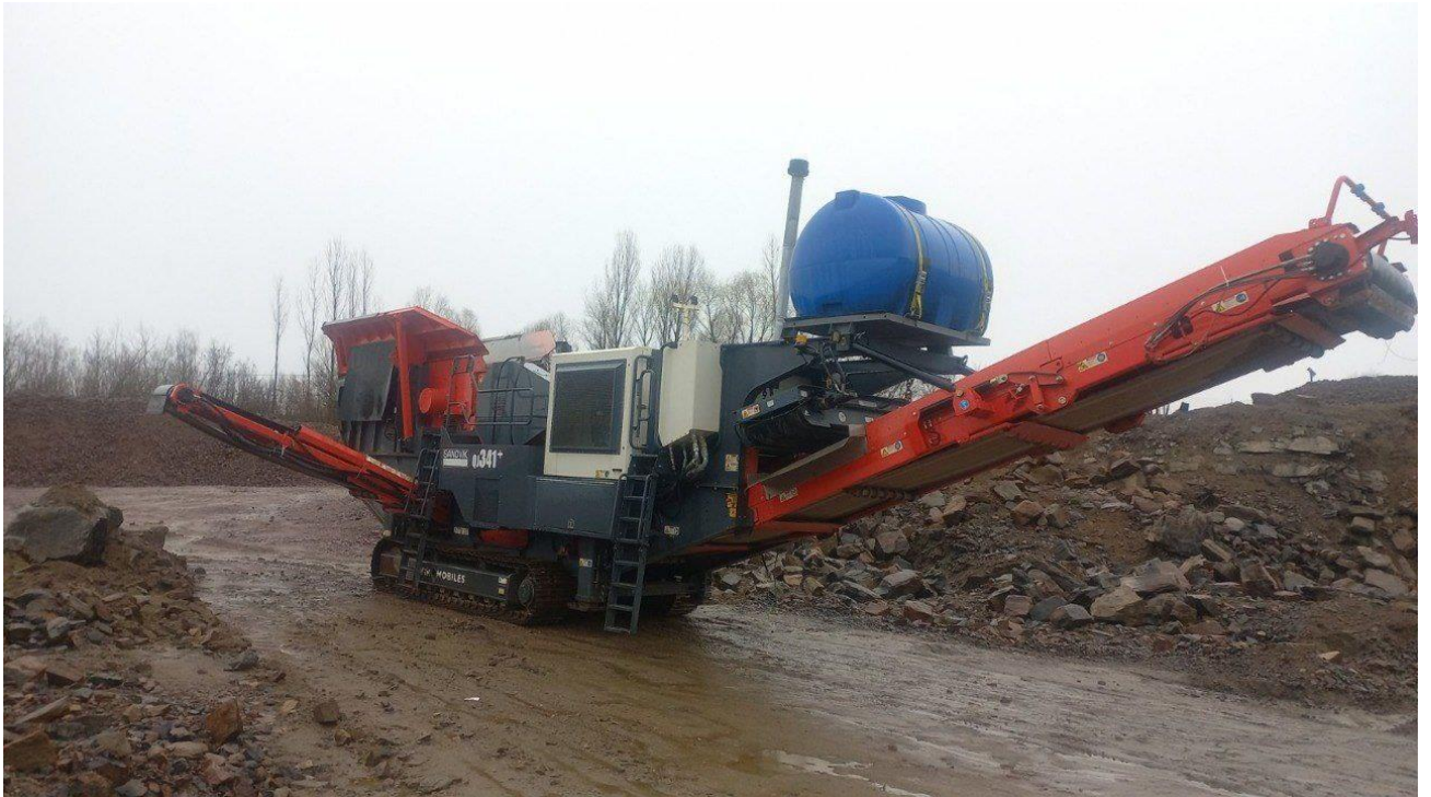
Рис.3 Самохідна дробарка із зрошувальною системою
