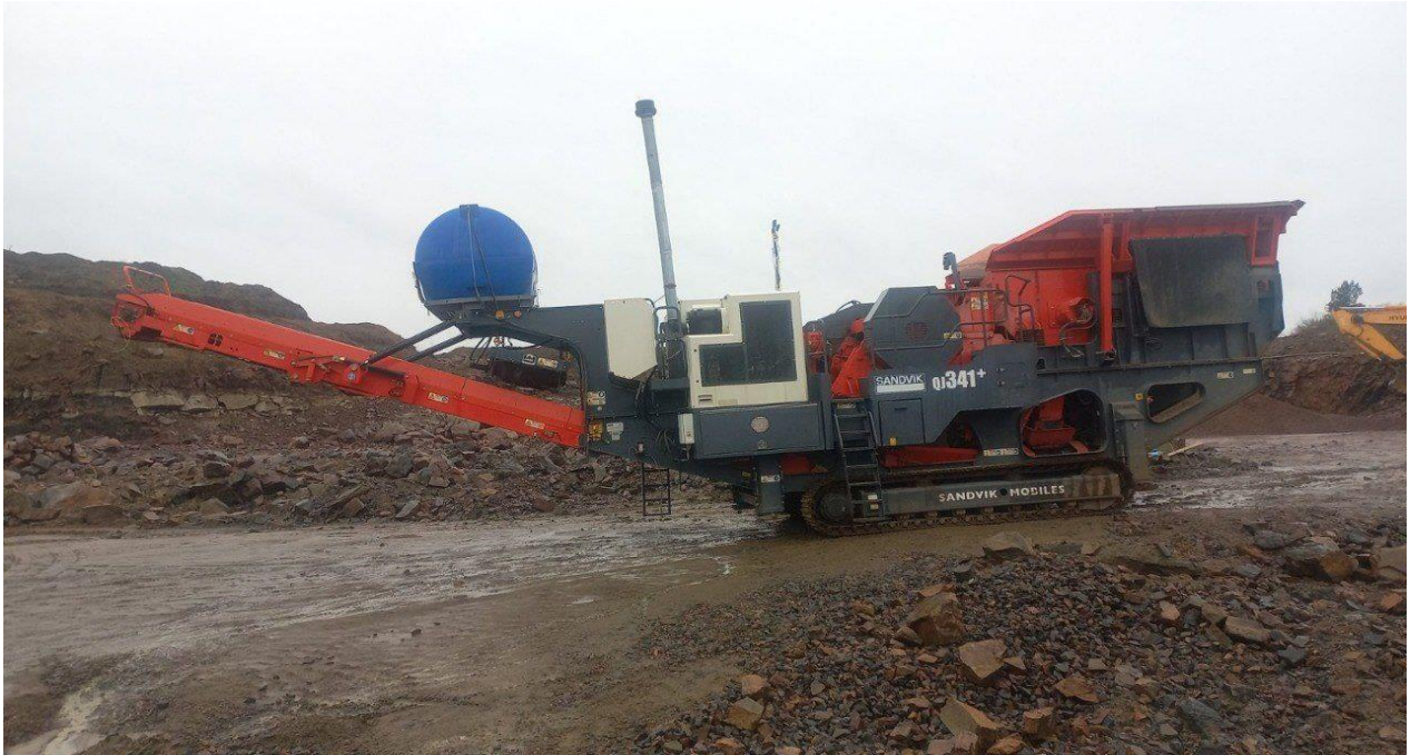
Рис.1 Самохідна дробарка із зрошувальною системою
